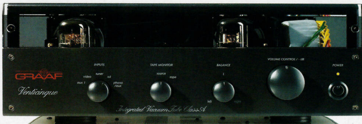
Schön gestaltet: Die massive Alu-Front und die darüber liegende Acrylglas-Scheibe, die den Blick auf die Röhren freigibt.
