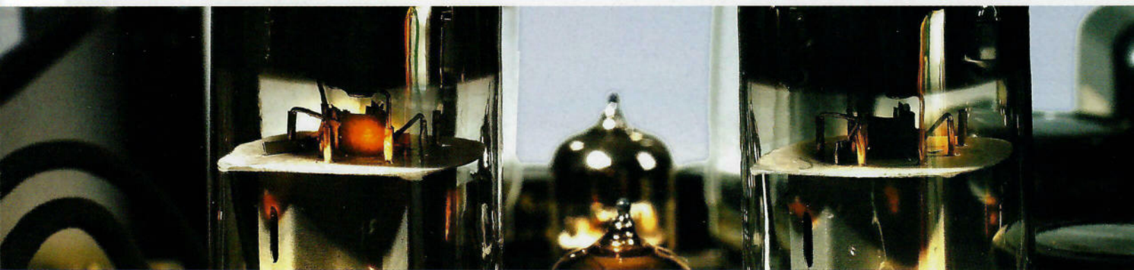
Technische Ästhetik: Die sorgfältig gefertigten Systeme der beiden hintereinander stehenden russischen Röhren vom Typ Sovtek 6L6.
