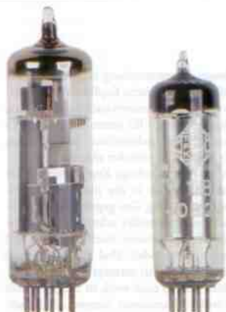
Links die Signalaröhre PCL86, rechts die Stabilisatorröhre STV 108/30
