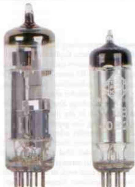
Links die Signalaröhre PCL86, rechts die Stabilisatorröhre STV 108/30
