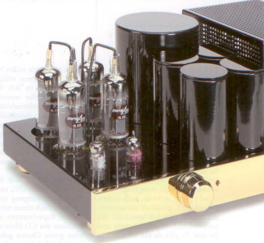
Die Abdeckhauben über dem Röhrenensemble sind serienmäßig und fest montiert. Offener Betrieb – wie hier fürs Foto – ist sicherheitshalber nicht vorgesehen
